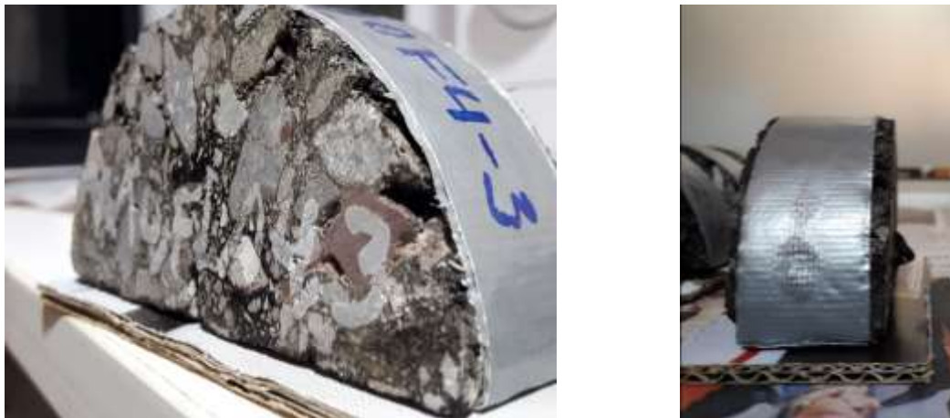
Figura 3-8 Detalles de cinta para afirmar probetas durante exposición a microondas
