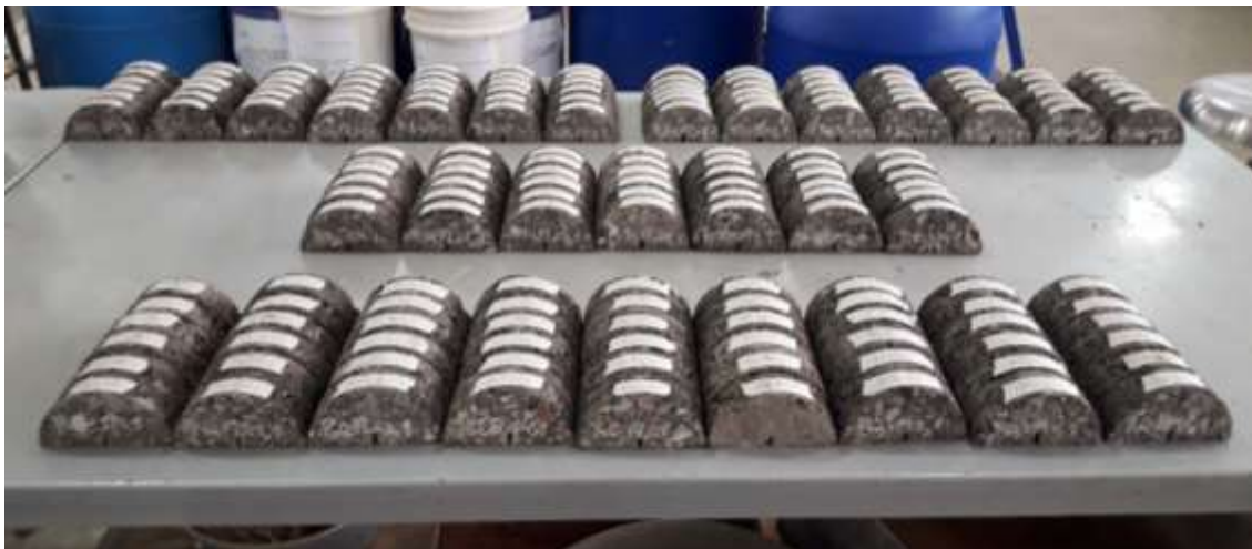
Figura 3-5 Probetas cortadas en cuartos y con hendidura para ciclos de flexión-reparación
