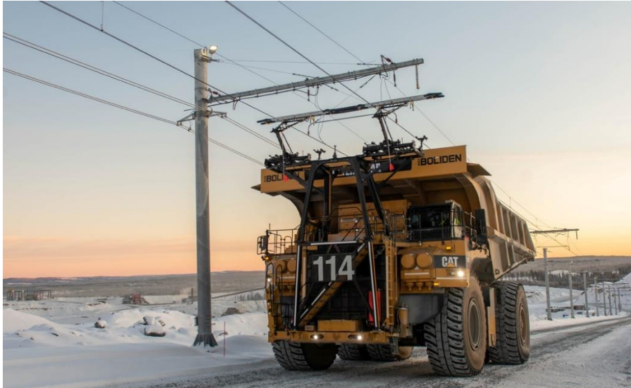
Figura 3: CAEX conectado a línea Trolley Assist en Suecia (miningmagazine.com).
