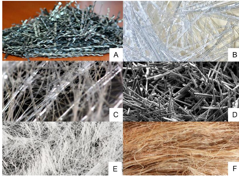
Imagen 1: Fibras de diferentes materiales utilizadas para variados usos en la industria de la construcción. A) Fibras de Acero, B) Fibras de Polipropileno, C) Fibras de Vidrio, D) Fibras de Carbono, E) Fibras de Polimeros, F) Fibras vegetales.
