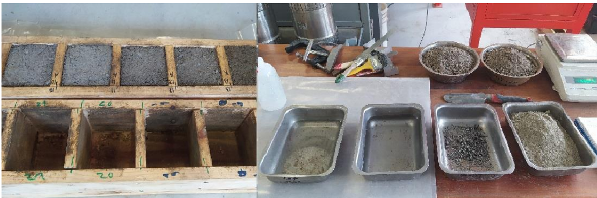
Imagen 11: A la izquierda los moldes de madera utilizados para el depósito y solidificación del hormigón. A la derecha los materiales pesados y separados para una tirada de hormigón.
