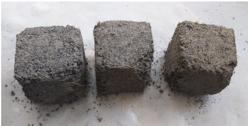
Imagen 17: Probetas con 1,2% de fibra vegetal de yute desquebrajándose.
