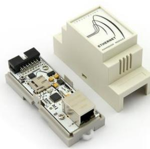
Ilustración 2-22. Módulo Ethernet
