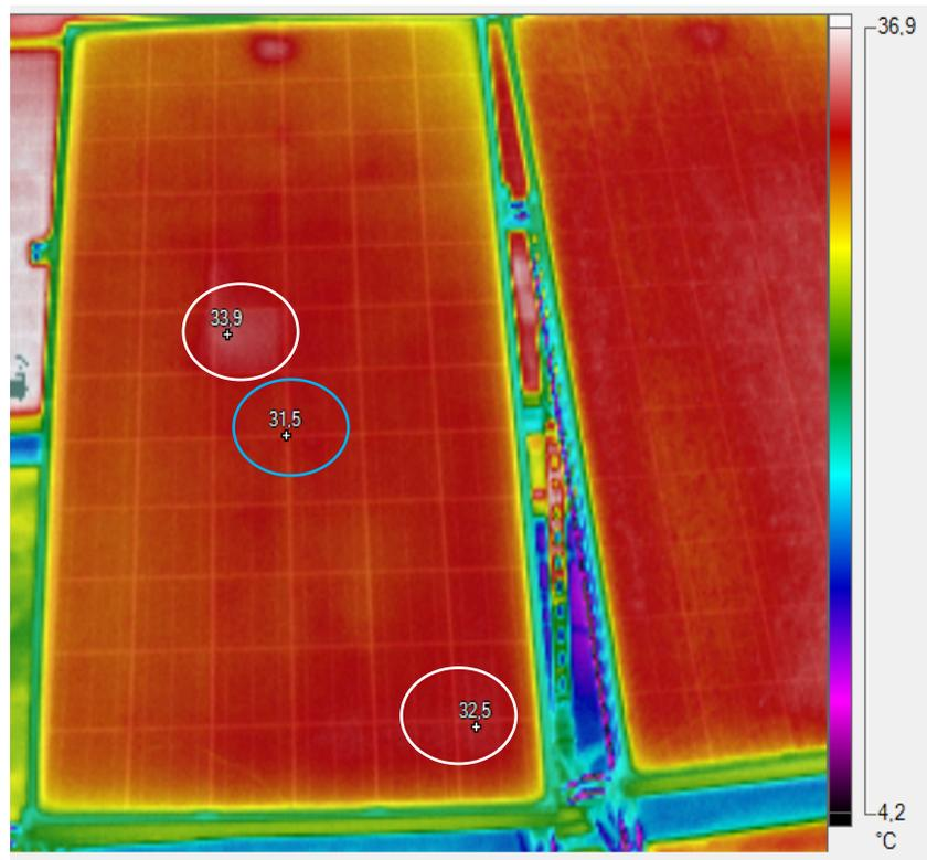
Figura 6-11: muestra los puntos del panel en que la temperatura sobrepasa la esperada (círculos blancos) y la temperatura del punto central del modelo (círculo celeste).
