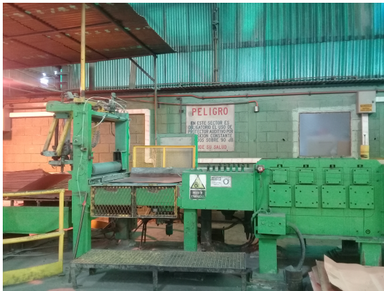
(a) Máquina preparadora de hojas de partida.
