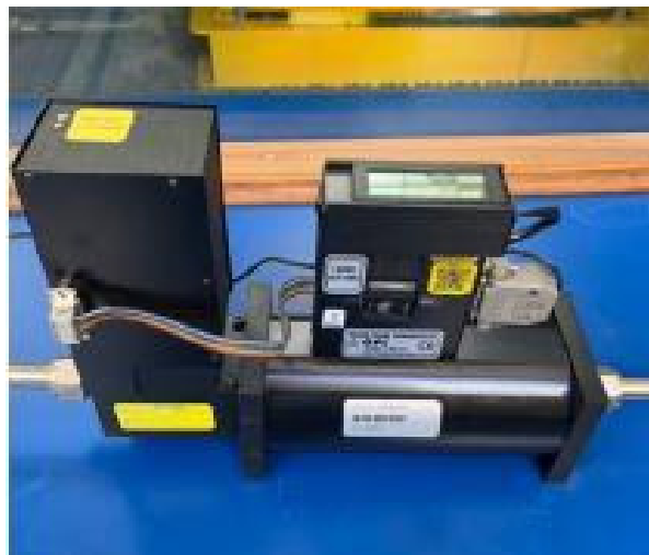
Figura 2.11. Controlador de flujo.
