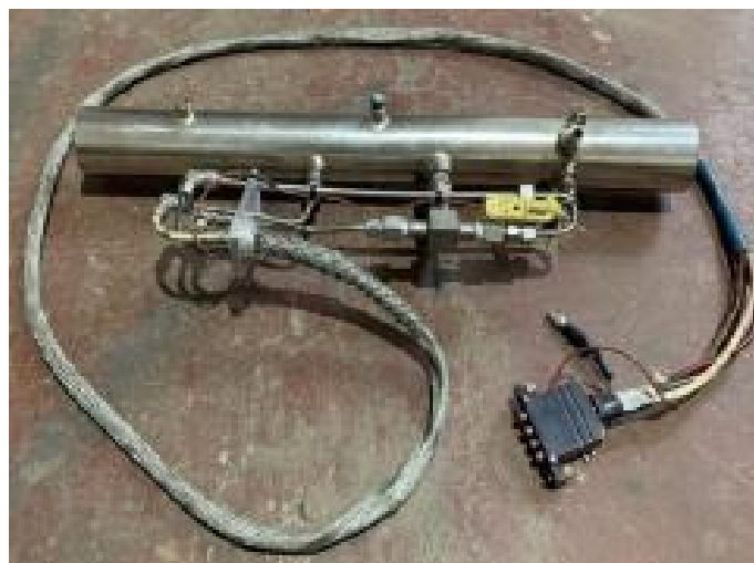
Figura 2.7. Tubo de flujómetro de diámetro 2,5".
