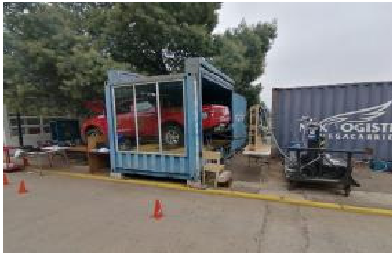
Figura 2.2. Camioneta Mistubishi L200 en freno dinamométrico.
