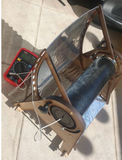
Figura 26 - Fotografía montaje para el control de temperatura con multímetro
