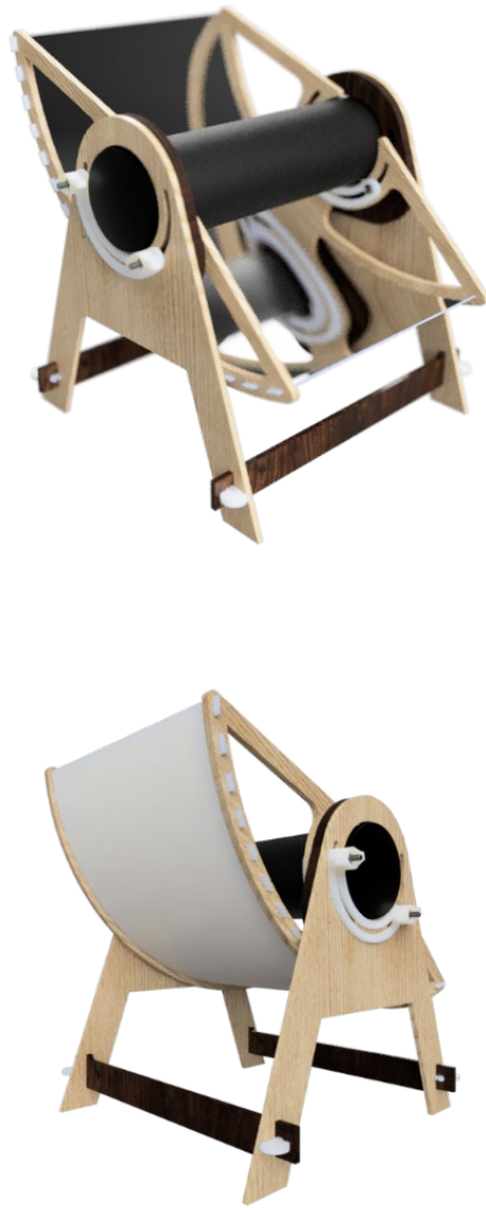
Figura 15 - Vistas isométricas propuesta final horno solar transportable
