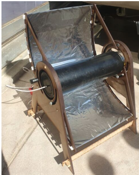
Figura 27 - Fotografía frontal derecha montaje de control de temperatura con multímetro
