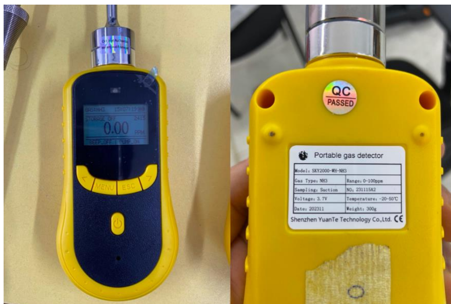
Figura 7: Detector portátil de amoníaco para monitoreo de niveles en el laboratorio
