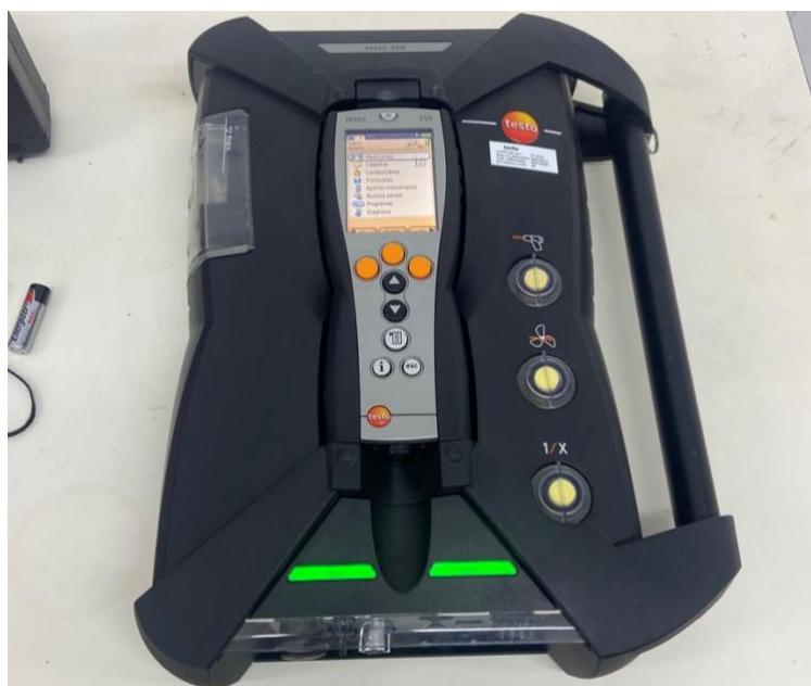
Figura 28: Equipo de medición Testo 350
