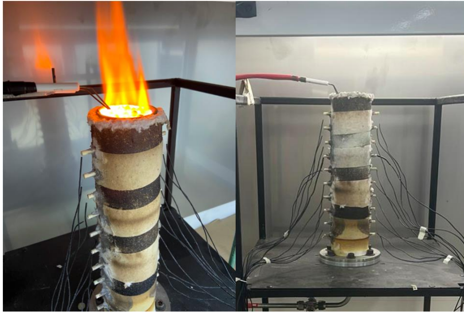
Figura 4: Quemador de medios porosos de acero inoxidable. A la derecha apagado y a la izquierda al momento del encendido antes que se confine la llama
