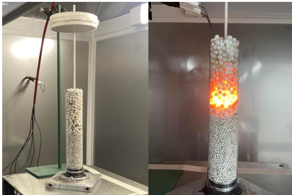
Figura 3: Quemador de cuarzo de MPI utilizado en las pruebas. A la izquierda apagado, a la derecha encendido
