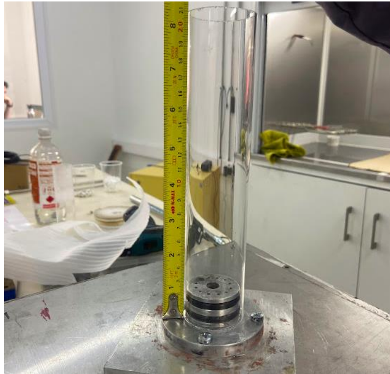
Figura 21: Cilindro de cuarzo, carcasa del quemador
