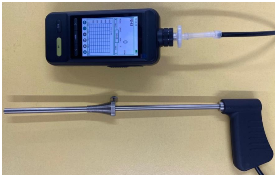
Figura 29: Equipo de medición de amoníaco con su sonda
