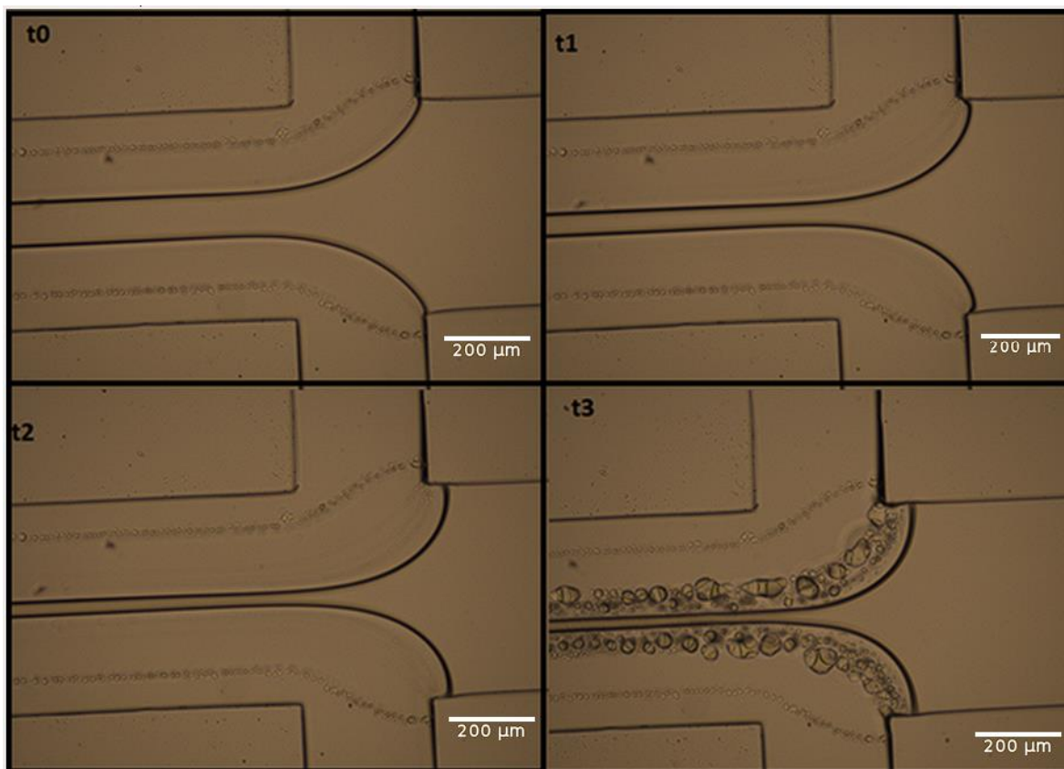
Figura 58. Ensuciamiento por operación del chip. FRR 30 Chip Flow focusing T
