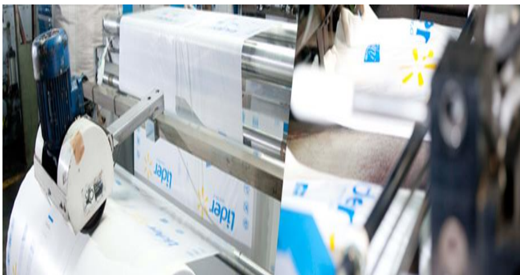
Imagen N°1.4: Proceso corte y sellado.
