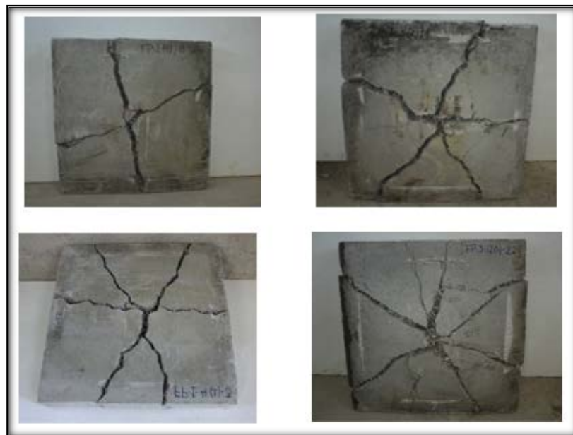
Ilustración 9 diferentes modos de falla, con variación en el número de grietas radiales.
