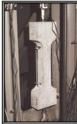
Ilustración 3 ejemplo probeta tipo hueso de perro (Reinhardt , 1998).
