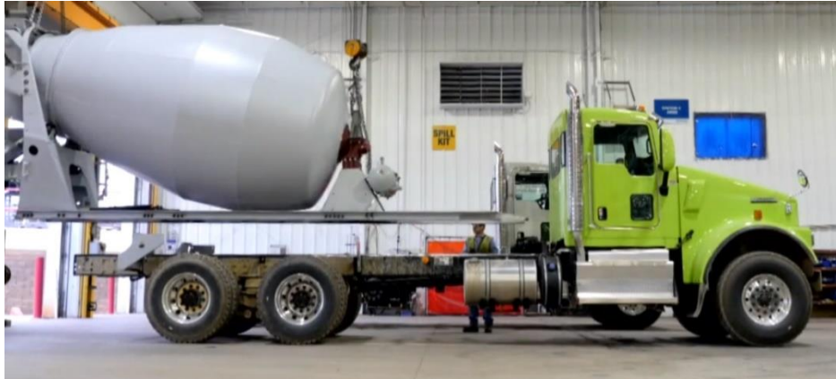
Imagen N°12 muestra la hormigonera siendo instalada sobre el chasis del camión. [32]
