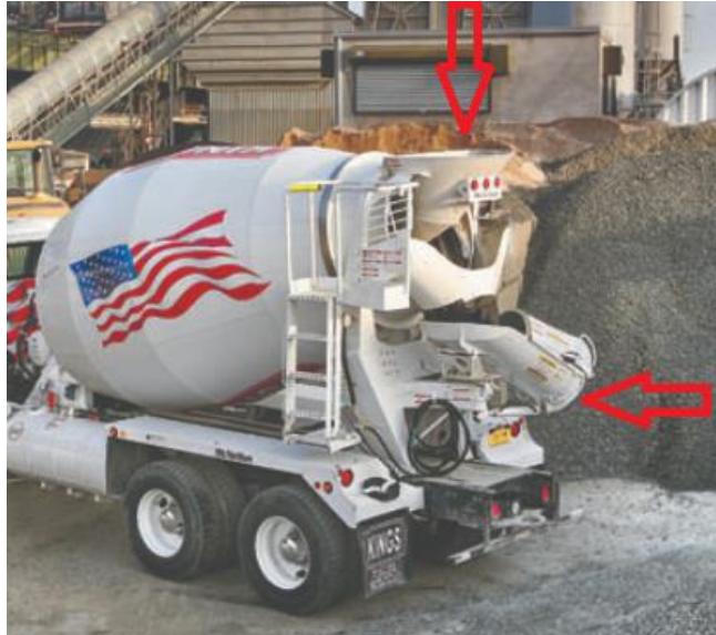
Imagen N°24 se muestra la zona de carga y descarga de material. [31]
