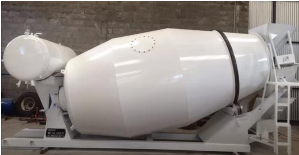
Imagen N°16 tolva giratoria, en la esquina superior izquierda se puede ver el tanque de agua y en el costado derecho la zona de carga y descarga. [32]
