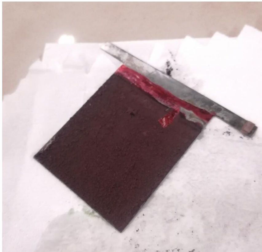
Figura 17: Depósito de pasta en cátodo.
