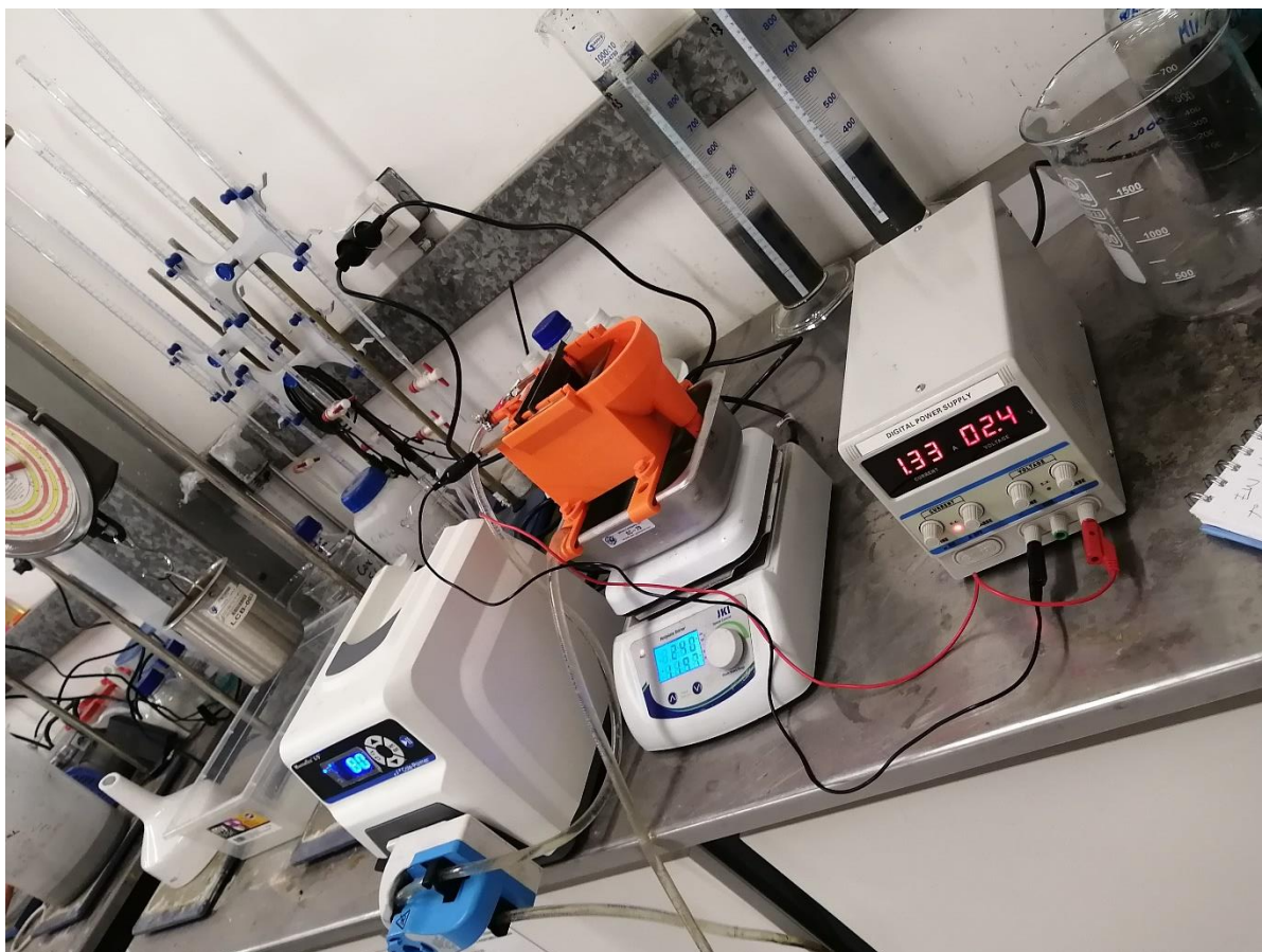
Figura 14: Montaje electroobtención de cobre.
