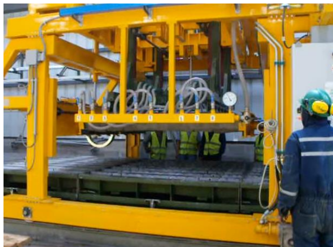
Foto 2-14: Moldaje de durmiente reciclado
