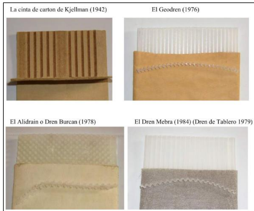
Figura 2-3: Foto de cuatro tipos de drenes prefabricados. Fuente: Referencia (4).
