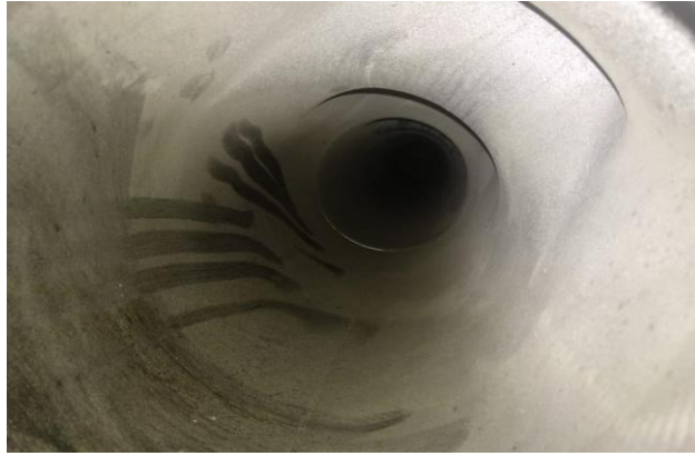
Figura 4-5: Interior de múltiple de admisión contaminado con sílice
