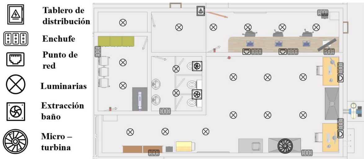
Figura 41: Esquema del sistema eléctrico interno.
