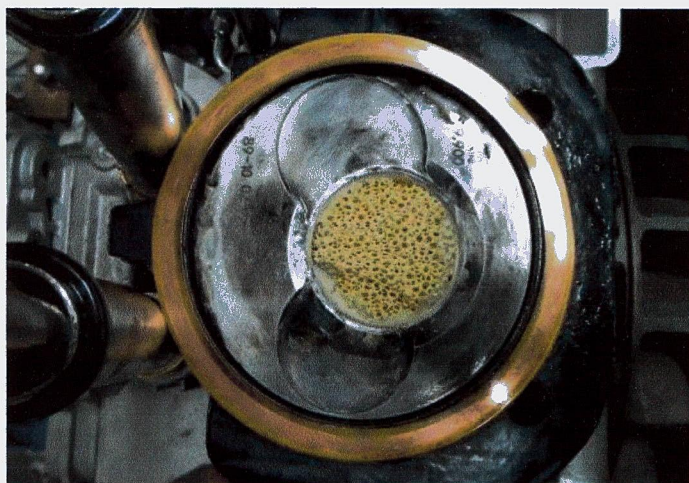
Figura 4.9. Adhesión del medio poroso de zirconia al pistón del motor.
