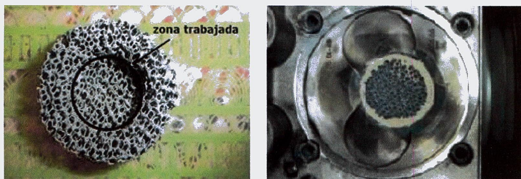
Figura 4.8. Adaptación del MP de SiC para su instalación (izquierda); Adhesión del MP de SiCal pistón del motor (derecha).
