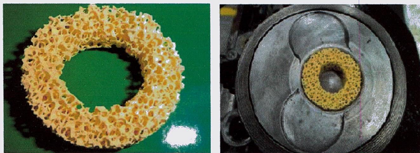
Figura 4.11. Geometría en forma de anillo (derecha); Anillo de zirconia en el pistón (izquierda)
