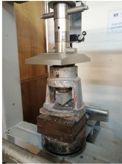
Imagen 4: Ensayo a compresión, equipo Tonindustrie Berlín – West.
