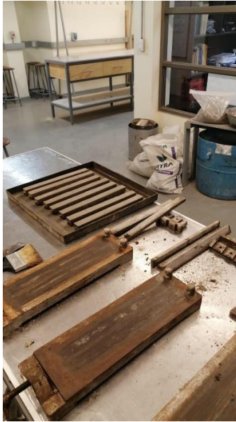
Imagen 1: Desmolde probetas de retracción.
