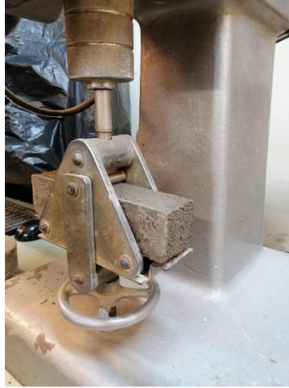
Imagen 3: Ensayo a flexotracción, equipo Tonindustrie Berlín – West.
