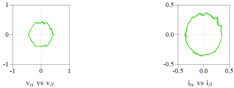
Figura 4.41: Trayectoria fasores espaciales de tensión y corriente con \omega_{s_{ref}} = 0,4 pu, i_{d_{ref}} = 0,35 pu e i_{q_{ref}} = 0 .
