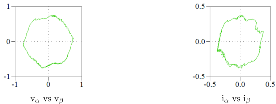
Figura 4.42: Trayectoria fasores espaciales de tensión y corriente con \omega_{s_{ref}} = 0,7 pu, i_{d_{ref}} = 0,35 pu e i_{q_{ref}} = 0 .
