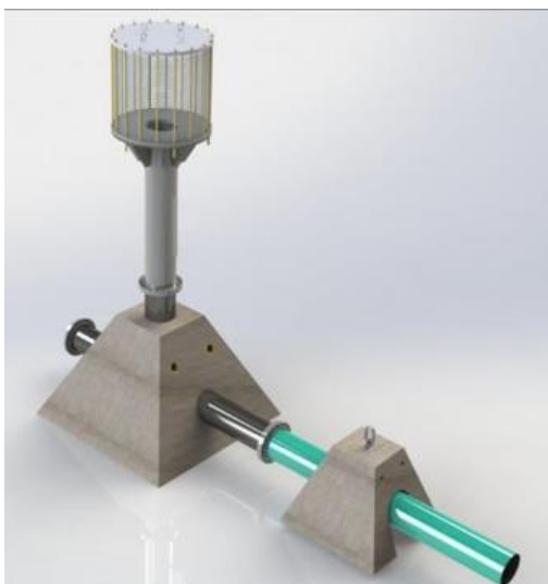
Figura 9. Captación de agua de mar, filtro y muerto de sujeción
