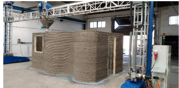
Figura 15: sistema aporticado de impresión móvil (Fuente: https://bemore3d.com/ ).
