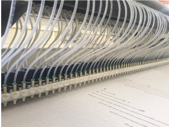
Figura 10: Máquina D-Shape con cabezal de impresión compuesto por 300 boquillas (Fuente: https://d-shape.com/what-is-it/the-process/the-concept/ ).
