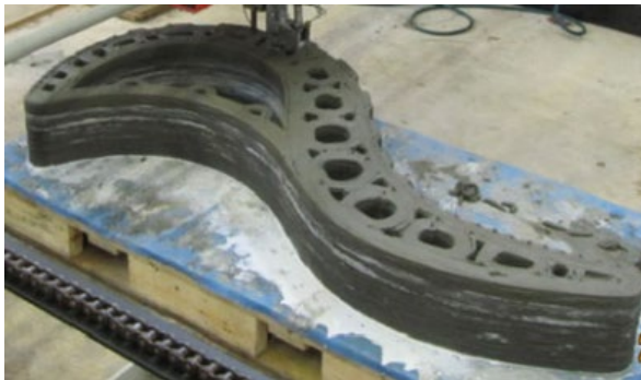
Figura 7: Objeto fabricándose con el método Concrete Printing (Fuente: Le, y otros, Mix design and fresh
