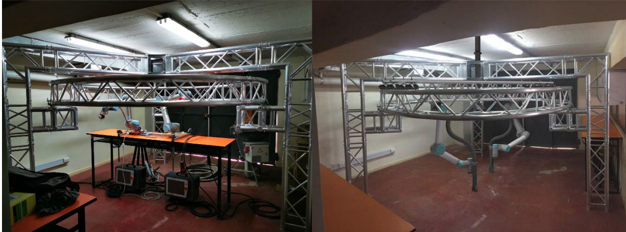
Figura 31: Prototipo del sistema cooperativo multi-robot, montado en el laboratorio de SISCOM. Estado actual (izquierda), estado objetivo (derecha) (Fuente: González Böhme, García Alvarado, Quitral Zapata, & Valenzuela Astudillo, 2020).
