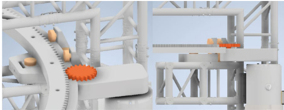
Figura 84: Propuesta de diseño 6 de guía circular de precisión y mecanismo de desplazamiento circular (Fuente: Elaboración propia).
