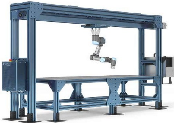
Figura 62: Extensor de rango 7th Axis para alcance aéreo (Fuente: https://vention.io/range-extender ).
