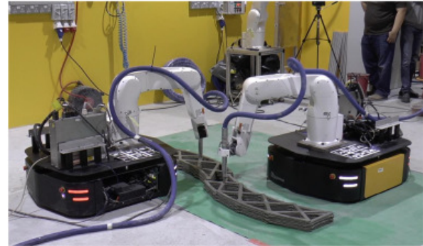
Figura 27: Robots imprimiendo simultáneamente una pared de hormigón (Fuente: Zhang, y otros, 2018).
