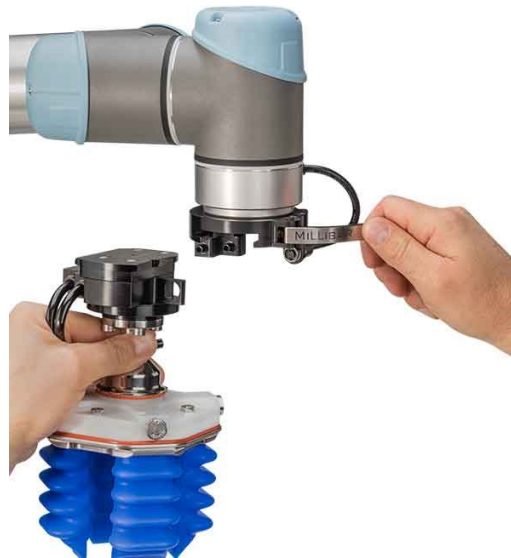
Figura 51: Cambiador de herramientas manual Millibar (Fuente: https://www.millibar.com/manual-tool-changer/ ).
