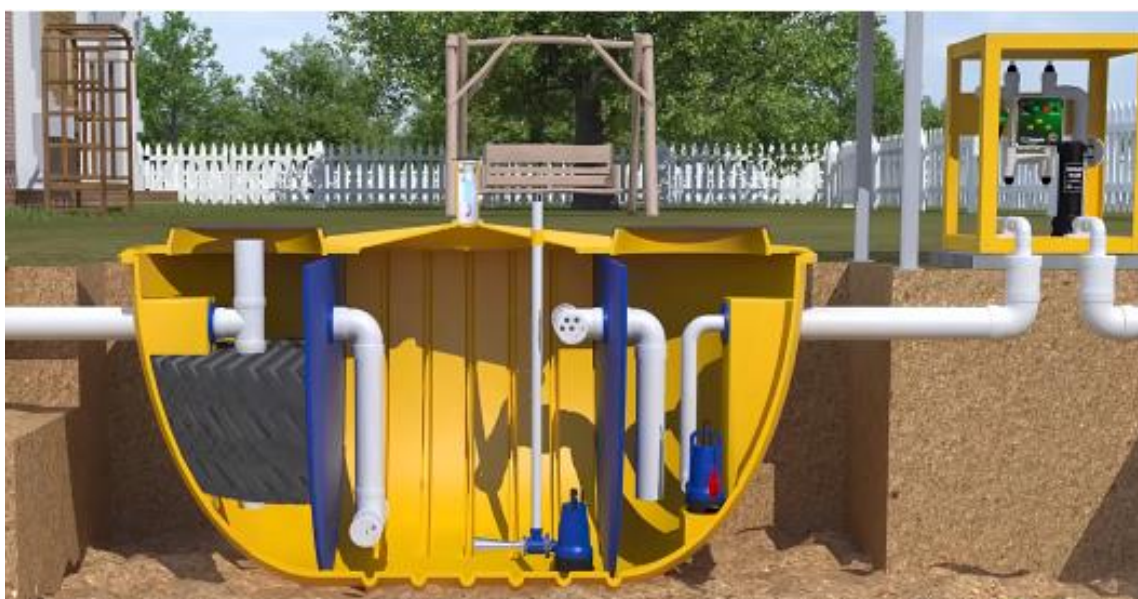
Ilustración 7: Diseño planta tratadora de aguas grises. Elaborado por NYF.
