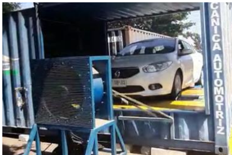
Figura 2-1. Renault Fluence Z.E sobre el Freno dinámico de Rodillos
