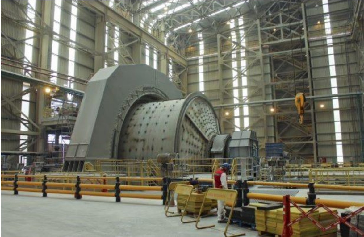
Ilustración 4: Molino SAG. Fuente: ecominingconcepts.cl.
