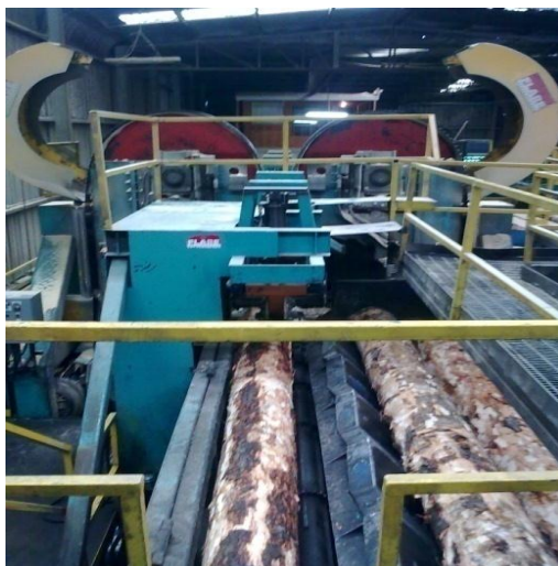
Figura n°6 Entrada a Twin Flare.
