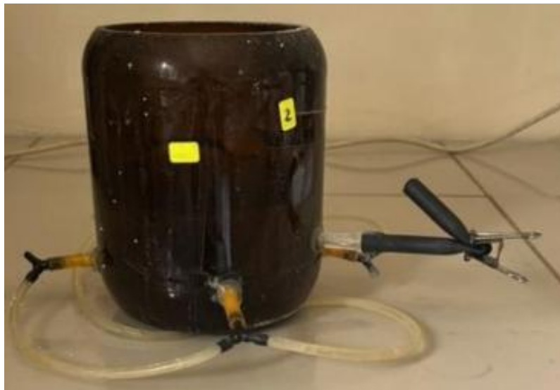
Figura 14. Fotografía de reactor de nitrificación y las mangueras de suministradoras de aire.
