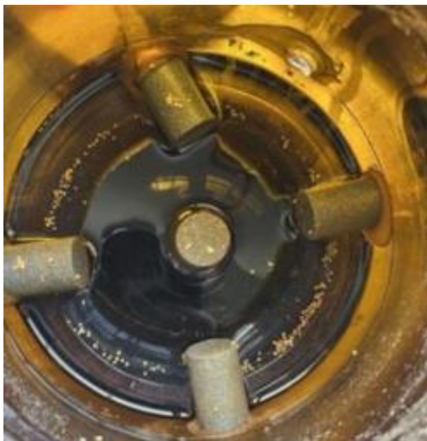
Figura 15. Fotografía del interior del reactor de nitrificación destacando los dosificadores de aire de piedra.
