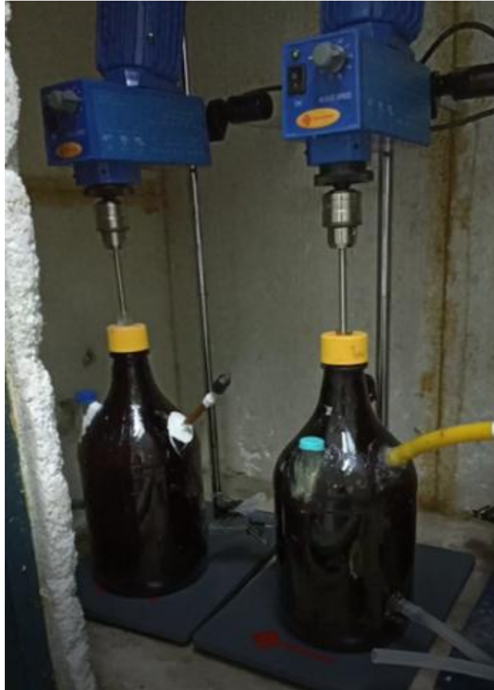
Figura 13. Fotografía de los reactores de Desnitrificación, con el agitador mecánico incorporado
