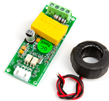
(b) Medidor de energía pzem-004t-100A
