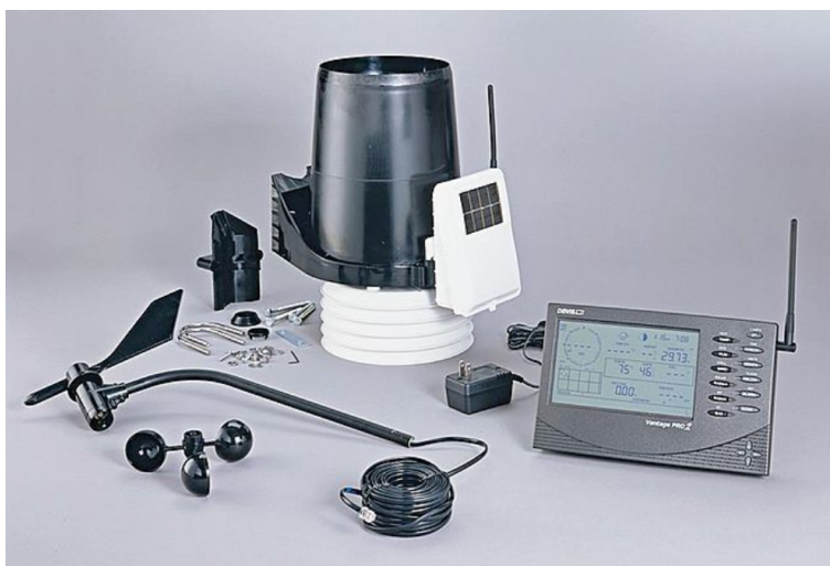
Figura 3.5: Estación meteorológica utilizada en el edificio en estudio (Modelo Davis 6152).
