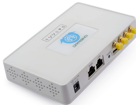
Figura 3.19: Alternativa seleccionada para el gateway LoRa
