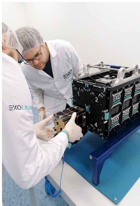
Figura 2-3: Instalación de un CubeSat (1U) al dispensador de la empresa ExoLaunch
