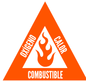
Figura 1.1: Triángulo de fuego en la combustión.
