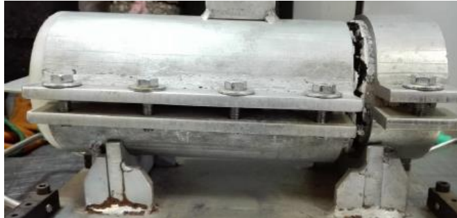
Ilustración 38: Testigo post-ensayo de corte LCB.
