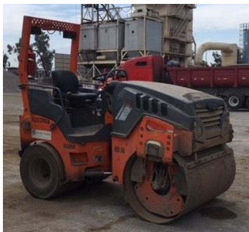
Ilustración 26: Rodillo mixto Hamm utilizado para compactar recapado en tramo de pruebas.
