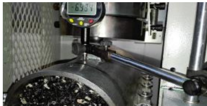
Ilustración 35: Detalle del dial utilizado para medir deformación.
