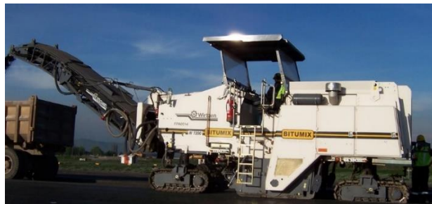
Ilustración 22: Fresadora de la división BTE de Bitumix S.A. utilizada para fresar tramo de pruebas.
