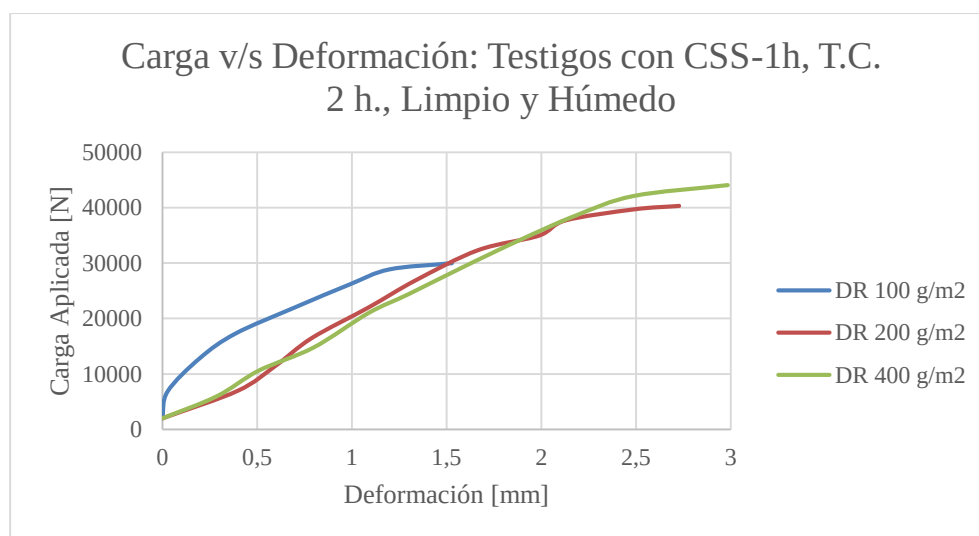
Gráfico 22: Curvas de carga v/s deformación para testigos sometidos a ensayo de corte LCB.
