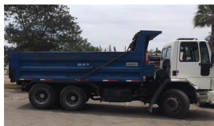
Ilustración 24: Camión tolva utilizado para provisión de mezcla asfáltica a terminadora.
