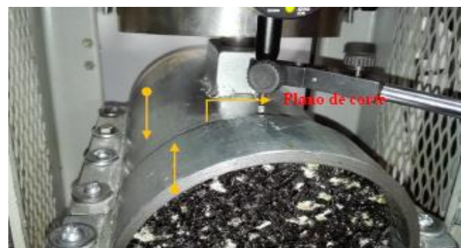
Ilustración 36: Detalle del plano de corte en sistema mordaza-testigo.
