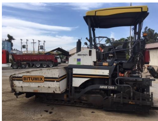
Ilustración 25: Terminadora Vögele utilizada para colocar recapado en tramo de pruebas.
