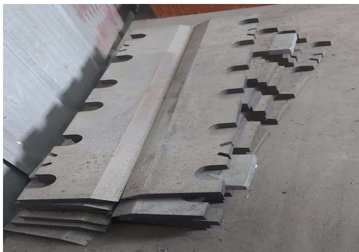
Figura 6-3. Cuchillos Chipeadora Bandit Modelo 2400
