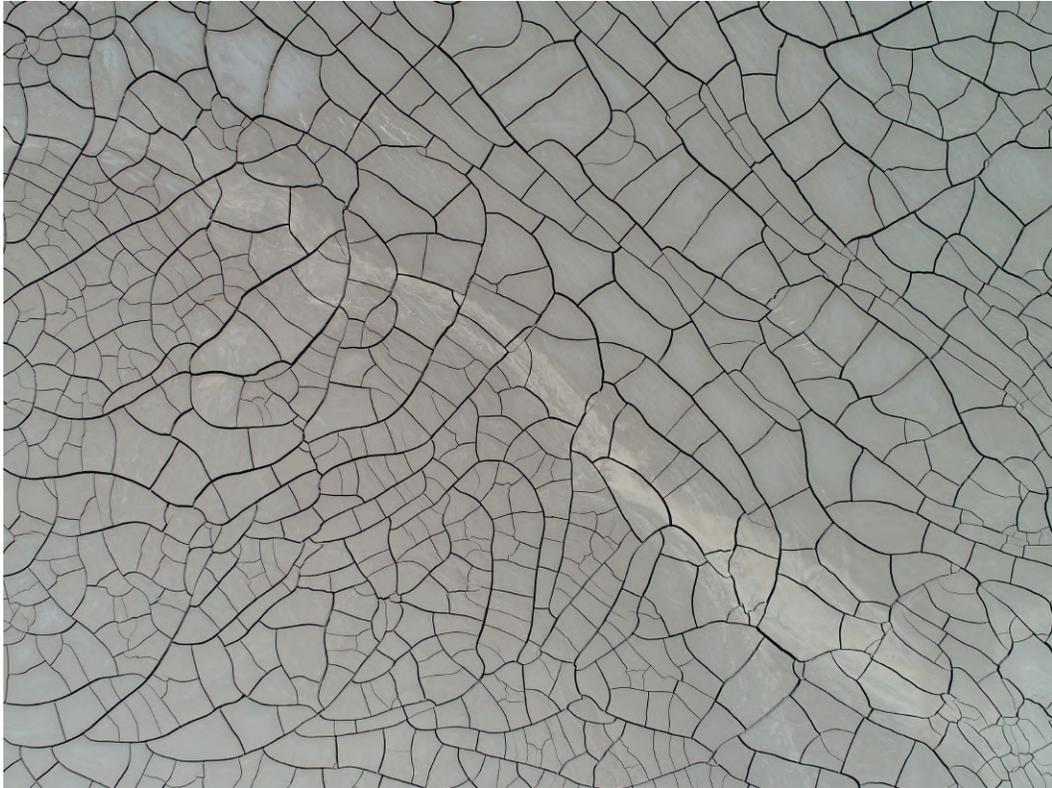
Figura 3.12: Agrietamiento Superficial en un Depósito de Relaves del Norte de Chile, del cual se Extrajo las Muestras MR1.
