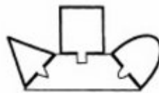
Figura 15: Esquema representativo arquitectura de tipo modular-ranura.
