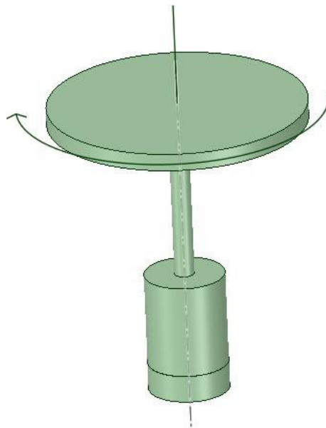
Figura 19: Esquema representativo motor-eje-disco.
