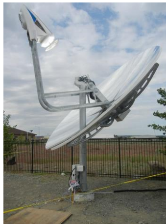
Figura 3: Prototipo de concentrador solar para reformado de metano. [34]
