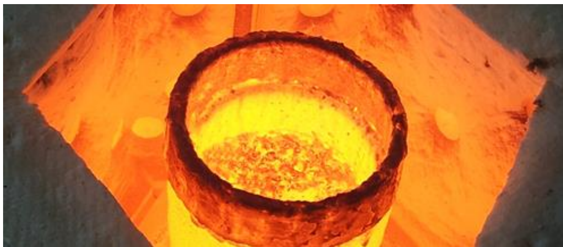
Figura 4: Horno de fundición que utiliza combustión en medios porosos como fuente de energía. [44]
