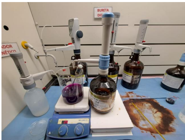
Ilustración 1-3. técnica de titulación en laboratorio
