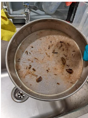
Ilustración 2-1 Proceso de tamizado de muestra en laboratorio
