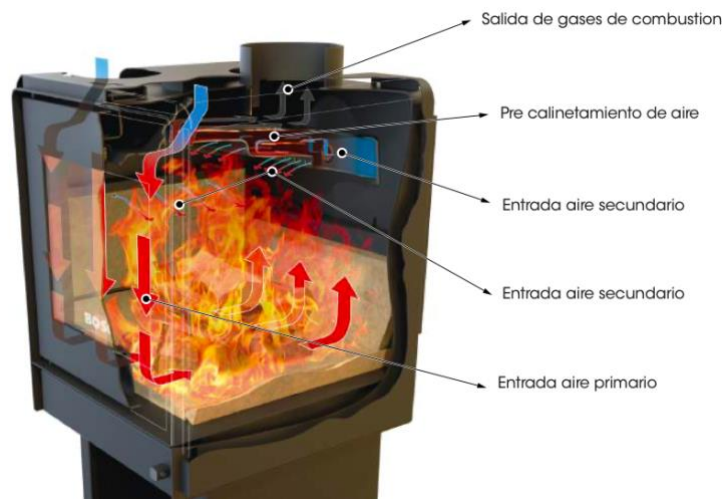
Figura 5: Vista en corte, estufa BOSCA con sistema de doble combustión.
