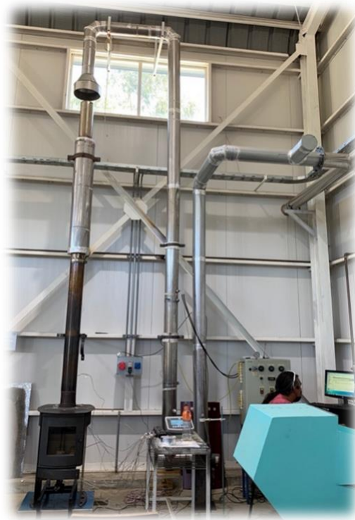
Figura 21: Montaje de la estufa Spirit 380 y el túnel de dilución en el Laboratorio de Energías Renovables.
