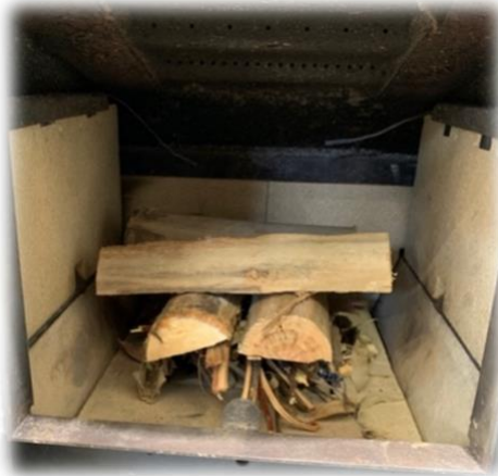
Figura 24: Carga de ignición y configuración para el encendido.
