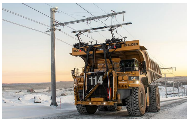
Figura 4.3 Camión CAEX asistido por sistema trolley
