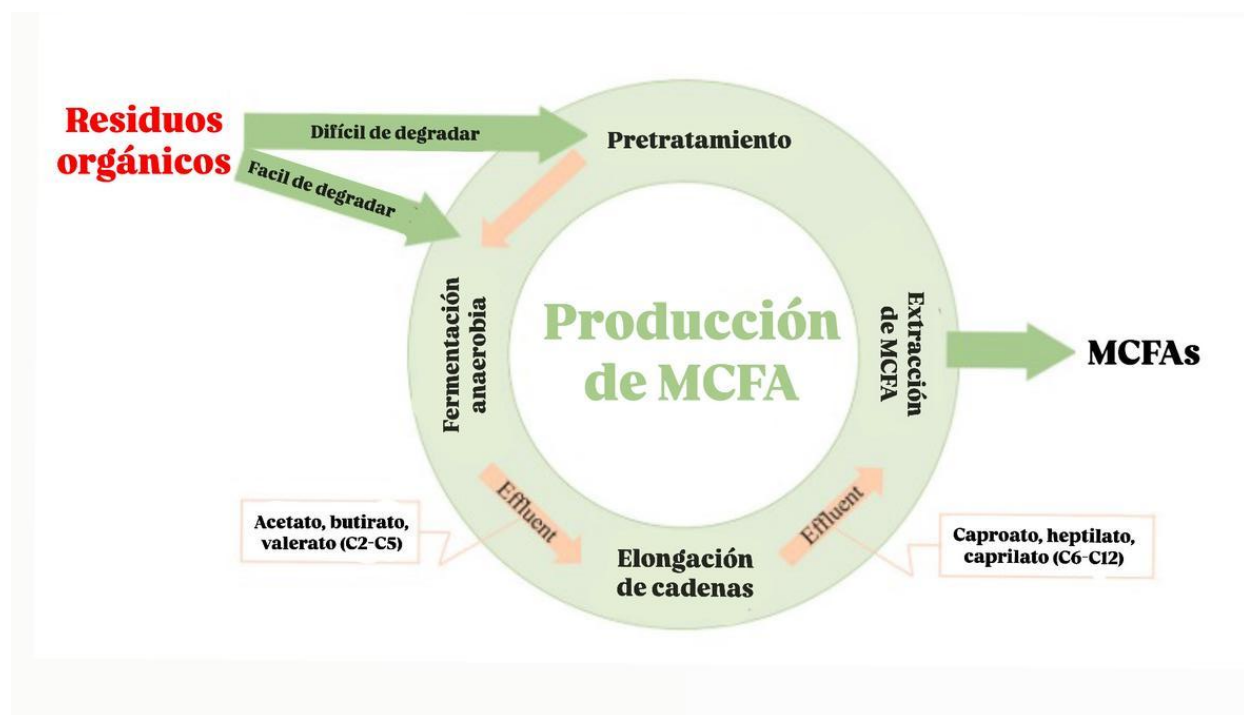
Figura 2: Esquema para el tratamiento de residuos orgánicos en la producción de ácidos grasos de cadena media. Traducido de: Wang, Yang, Cai, Zhang, Wu, Ma, Fu, Zhang, et al. (2023).
