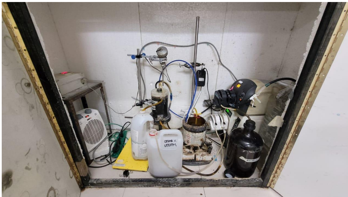
Figura 16. Configuración de los reactores acoplados CSTR – UAF en el laboratorio.
