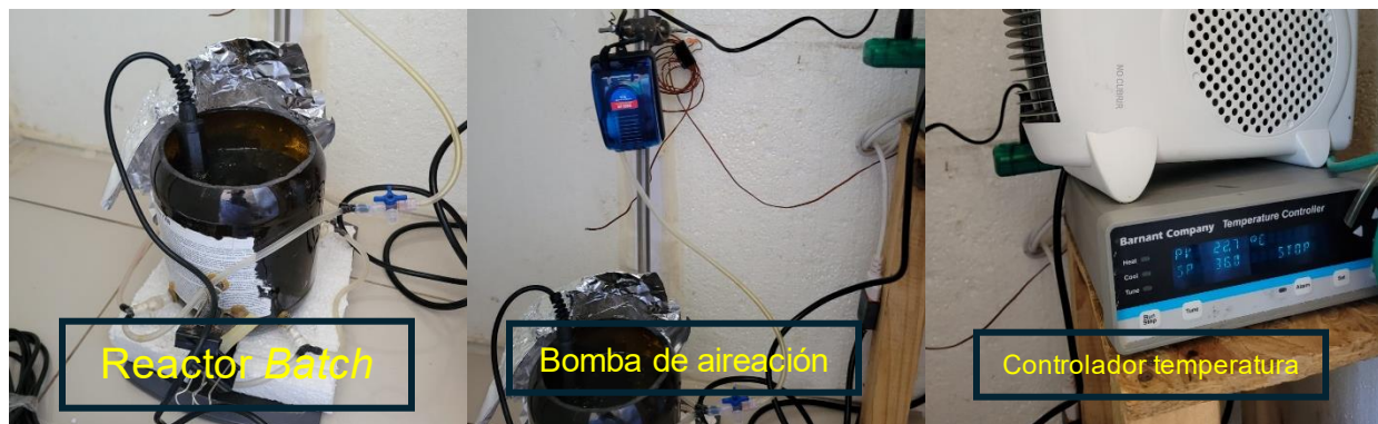
Figura 11. Configuración del reactor en la etapa de enriquecimiento de bacterias nitrificantes.
