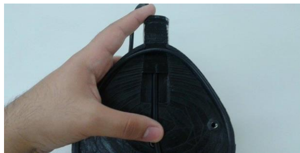
Imagen 102: Posición del cable e inserción de la tapa deslizante.
