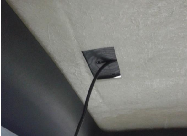
Imagen 103: Soporte L3 posicionado sobre el agujero en el techo del Twizy, vista desde el interior del auto.
