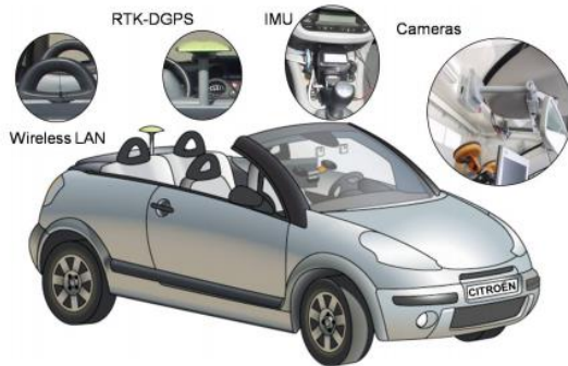
Imagen 18: Ilustración de Clavileño con imágenes de sus sensores. Fuente: (Milanés, Llorca, Vinagre, González, & Sotelo, 2010).
