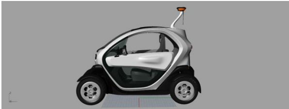
Imagen 46: Representación virtual del Modelo G3 montado en el Twizy.
