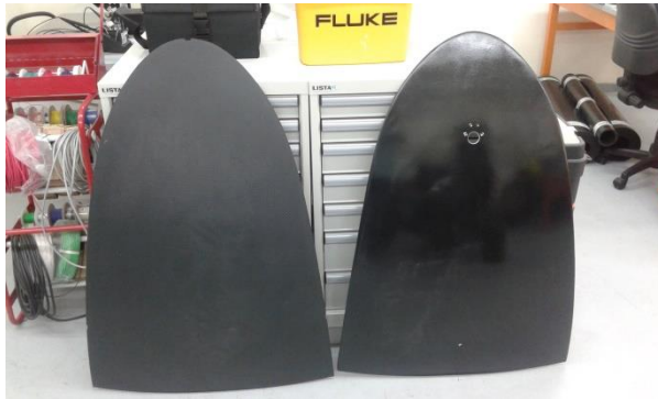
Imagen 40: A la izquierda el techo original del Twizy, a la derecha el techo réplica.
