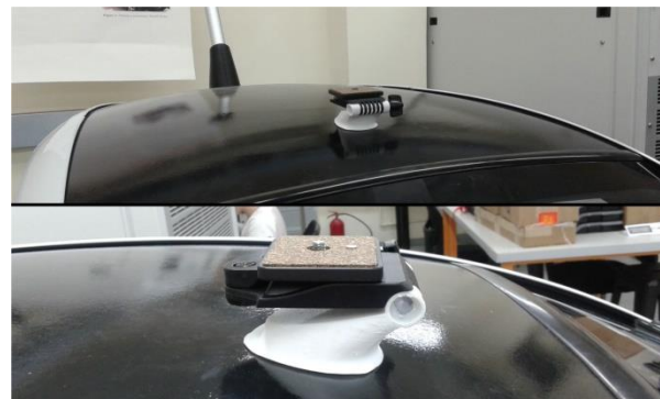
Imagen 91: Soporte del modelo L3 puesto sobre el techo del Twizy, en la posición que debería anclarse.
