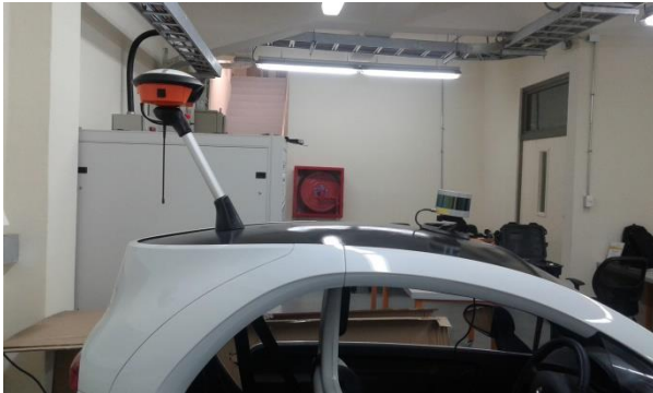
Imagen 110: Vista lateral derecha de los sensores montados en el Twizy.
