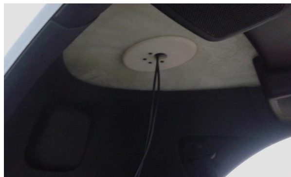
Imagen 108: Cables del GPS pasando al interior del Twizy.
