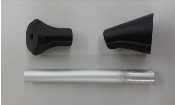
Imagen 81: Partes del modelo G5. En la parte inferior de la vara de aluminio se puede ver el espacio limado.
