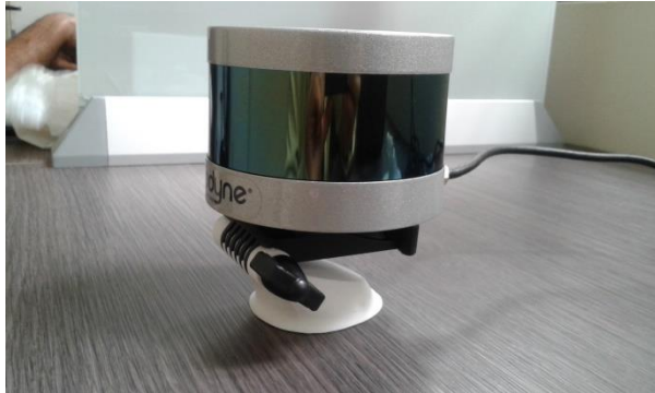
Imagen 92: Soporte del modelo L3 sosteniendo al sensor LIDAR.
