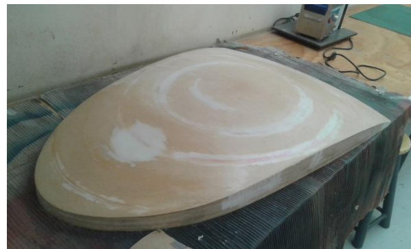
Imagen 36: Molde del techo finalizado.
