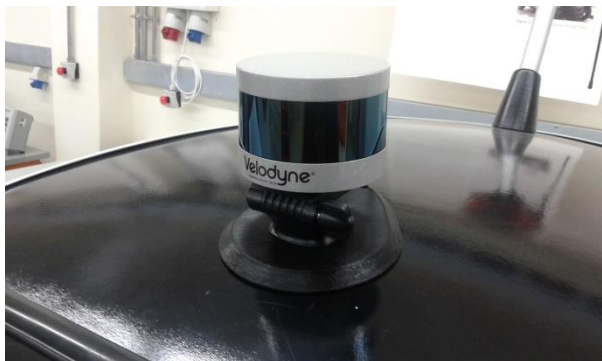
Imagen 106: Sensor LIDAR montado en el techo del Twizy.
