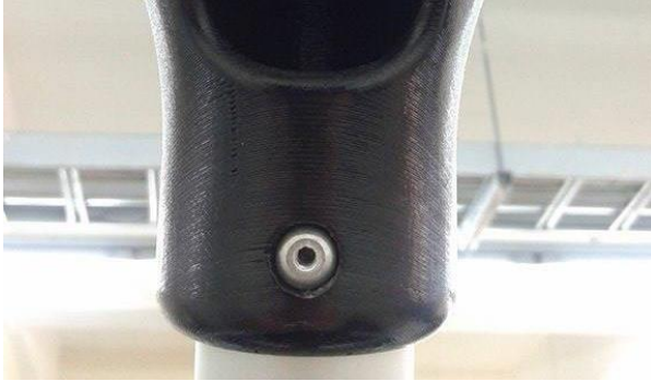
Imagen 86: Uno de los Remaches pop del Modelo G6.
