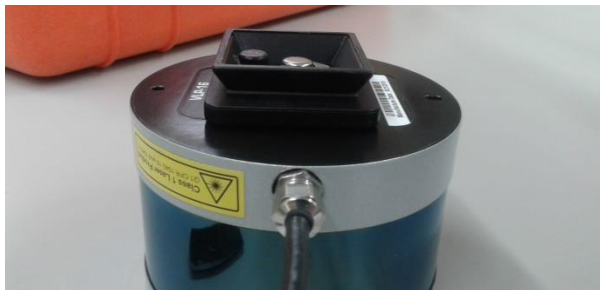
Imagen 99: Zapata del soporte L3 atornillada al LIDAR.
