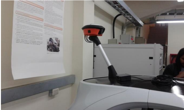
Imagen 84: Modelo G6 Pieza Final montado en el techo del Twizy.
