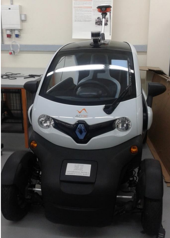
Imagen 113: Vista frontal completa del Twizy con sus sensores montados.
