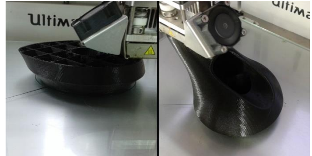
Imagen 82: Construcción de la pieza "conexión" del modelo G6 en la impresora 3D Ultimaker 2.
