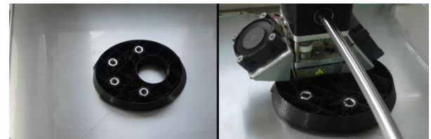
Imagen 80: A la izquierda las tuercas insertas en la pieza base, a la derecha la impresora 3D sigue imprimiendo luego de hacer los insertos.
