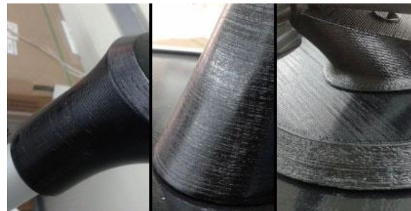
Imagen 114: Detalle de la superficie en las piezas impresas en 3D.
