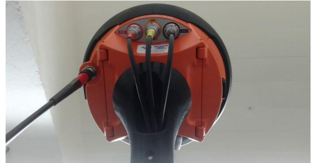
Imagen 83: Modelo G6 sosteniendo al sensor GPS con todos sus cables conectados.
