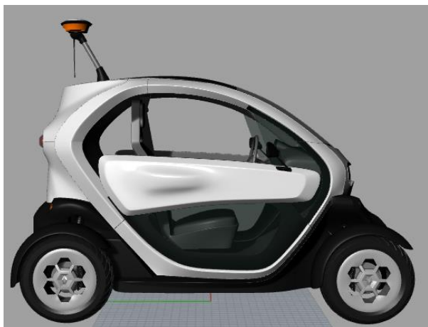
Imagen 52: Representación virtual del Modelo G5 montado en el Twizy.
