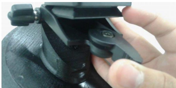
Imagen 100: Zapara posicionada sobre la base del soporte L3, a punto de ser asegurada.
