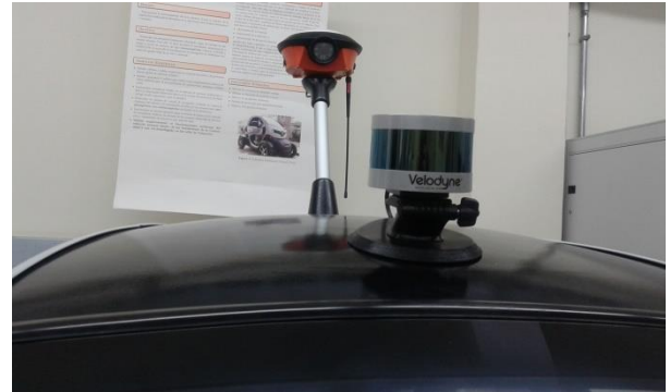
Imagen 112: Vista frontal de los sensores montados en el Twizy.
