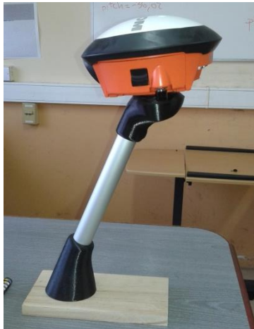
Imagen 78: Modelo G5 En una base de prueba sosteniendo el sensor GPS.
