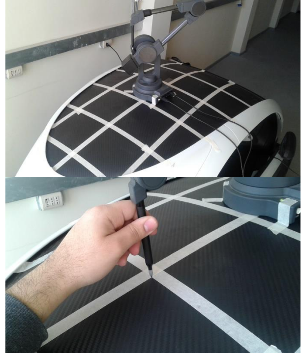
Imagen 33: Líneas de referencia y toma de cotas.
