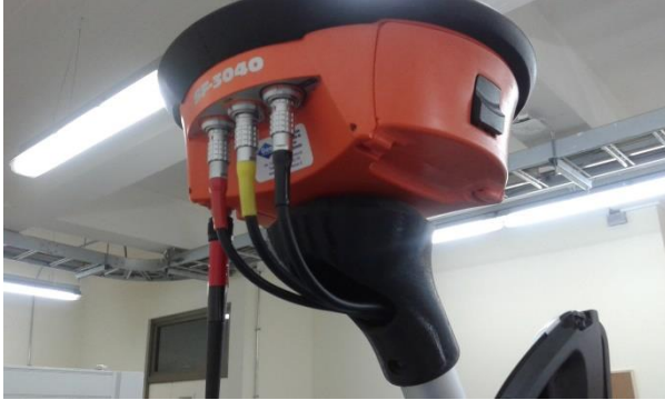
Imagen 109: GPS montado y conectado.
