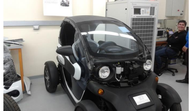
Imagen 38: Renault Twizy sin paneles laterales, traseros y frontales.
