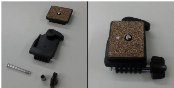
Imagen 59: Pieza del trípode usado en este soporte. A la izquierda un despiece, a la derecha la pieza armada.
