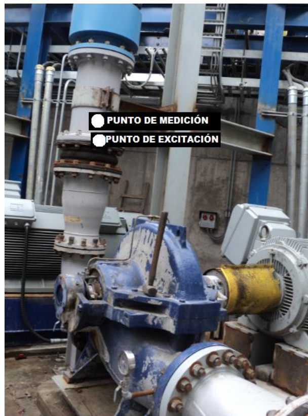
Figura 5.1, Configuración de excitación y adquisición en ensayo de respuesta ante impacto en bomba RABI8
