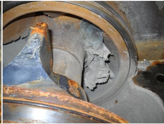
Detalle de plástico atrapado en impulsor de bomba retirada postura RABI 8.
