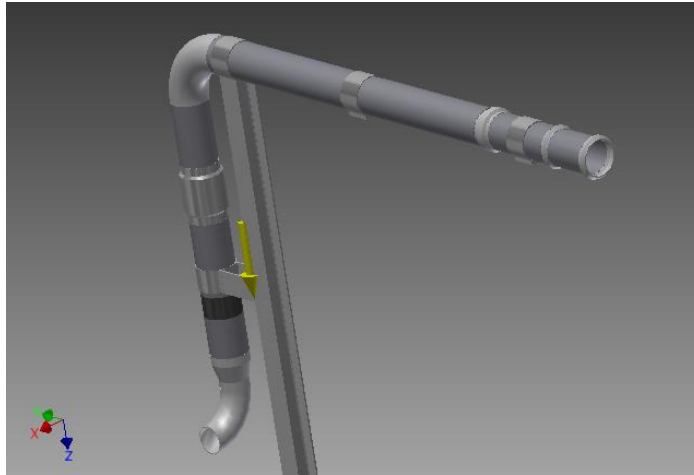
Figura 5.8, Modelo 3D utilizado en análisis modal.
