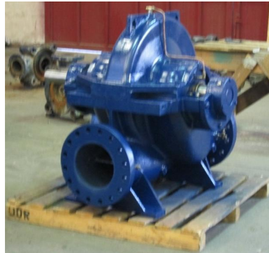
Figura 1.38, Bomba KSB OMEGA 250-600A diseño modificado con sello prensa estopa.
