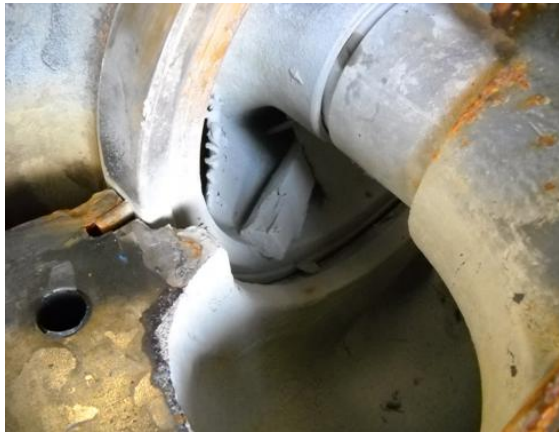
Detalle madera atrapada en impulsor de bomba retirada postura RABI 8.
