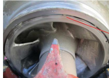
Figura 1.44 Excesiva holgura por desgaste en anillos sellos de cámara succión contra descarga.
