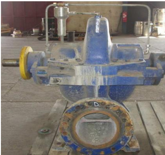
Figura 1.37, Bomba KSB OMEGA 250-600A diseño estándar con sello mecánico.
