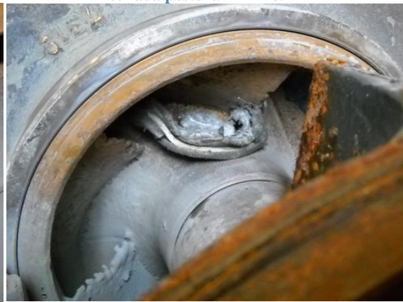
Detalle de guante atrapado en impulsor de bomba retirada postura RABI 8.
