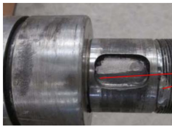
Figura 1.43 Desgarro en chavetero de afianzamiento pistón-eje.
