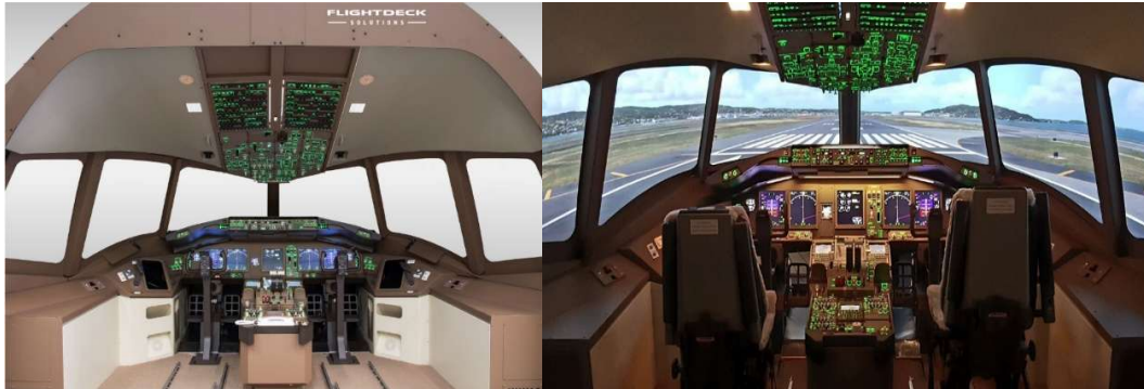
Ilustración 2.12: Entrenador categoría 7, basado en un B777.
