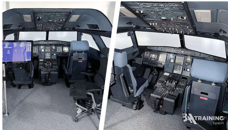
Ilustración 2.9: Entrenador categoría 4, siendo la primera con el requisito de tener una cabina cerrada.
