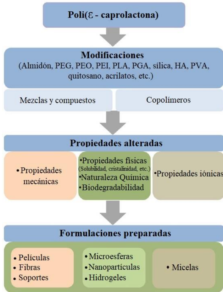
Figura 1. Posibles modificaciones y formulaciones de la PCL para alterar sus propiedades según el requerimiento. (Adaptado de Dash & Konkimalla, 2012).
