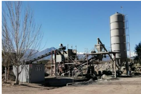
Figura 3-7. Planta de hormigones pre mezclados.
