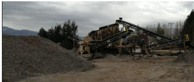
Figura 3-6. Planta de estabilizado.
