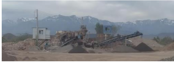
Figura 3-5. Planta de arena gruesa y gravilla
