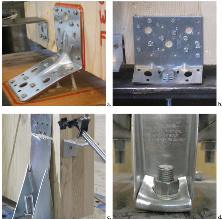
Figura 16. Mecanismos de falla inadecuados a nivel de conexión: (a) retirada de los clavos conectados al panel de piso CLT; (b) tracción del perno de anclaje, (c) rotura por tracción en la sección transversal neta de la brida metálica, y (d) pandeo del anclaje a los cimientos. (engineering structures,Elsevier).
