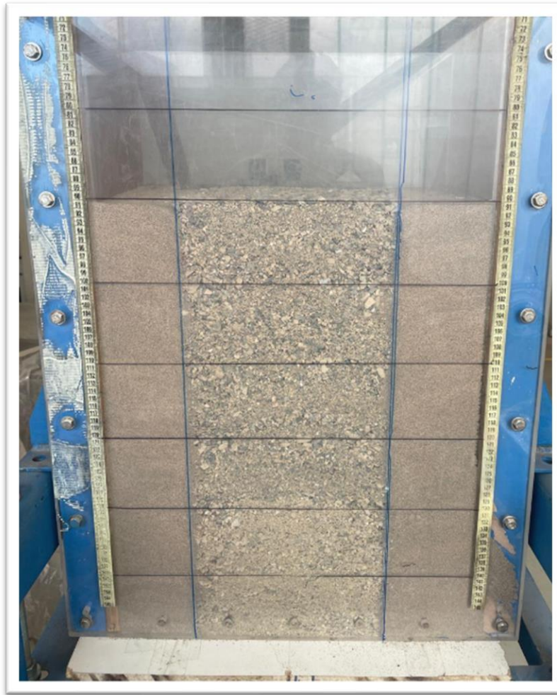
Ilustración 3: Caja con 6 capas de material en proceso de carga
