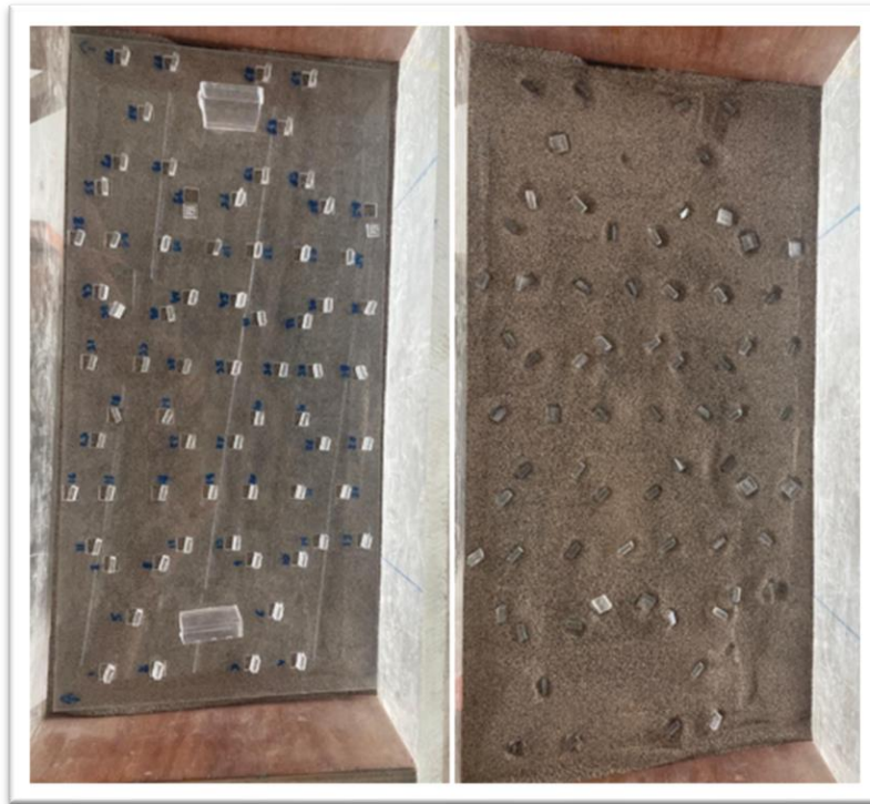
Ilustración 20: Marcadores puestos en placa de posicionamiento y en equipo.
