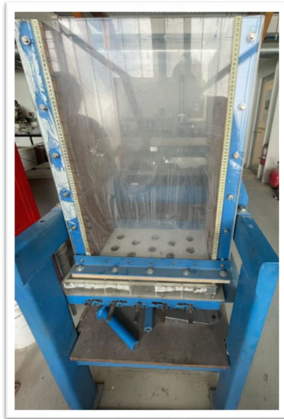
Ilustración 1: Equipo de simulación de hundimiento por bloques.
