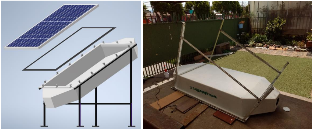
Figura 4.7. Humidificador. Izquierda, despiece del humidificador. Derecha, construcción de base metálica.
