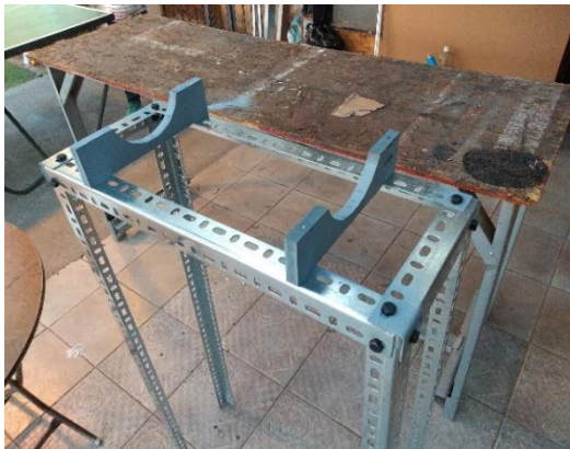
Figura 4.9. Construcción Humidificador. Izquierda, estructura de soporte con perfil de fijación. Derecha, instalación conectada al piping de agua y aire.
