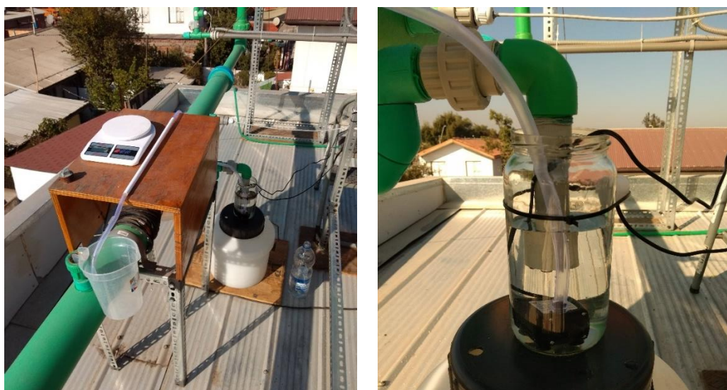
Figura 5.20. Arreglo utilizado para la calibración del medidor de destilado.
