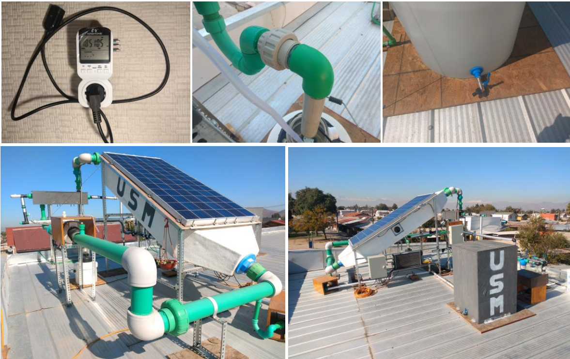
Figura 6.6. Mejoras. Arriba, temporizador marca Nashone, trampa de agua para destilado mejorada y válvula para recambio de agua. Abajo, estado final del equipo.
