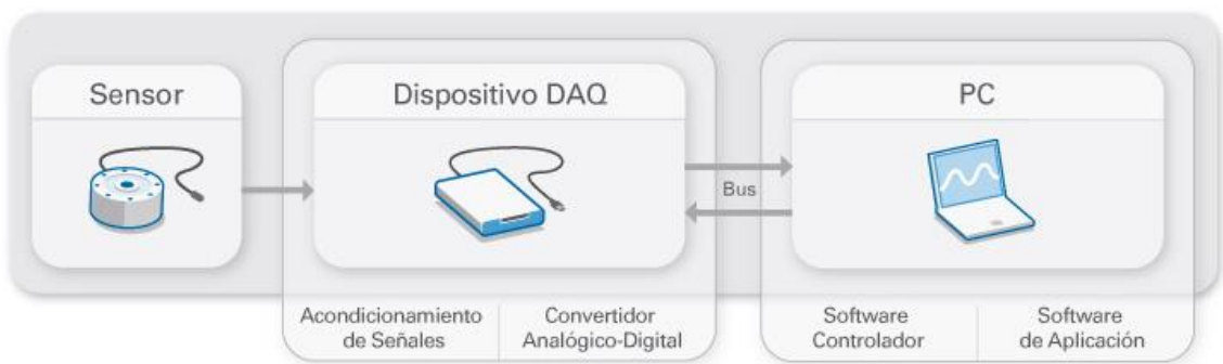
Imagen 2-1: Esquema básico de un sistema DAQ Fuente: Adquisición de datos National Instrument, 2016.
