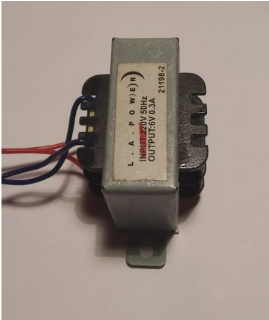
Imagen 2-4: Transformador Fuente: Fotografía transformador, (Hidalgo Rifo,2015)
